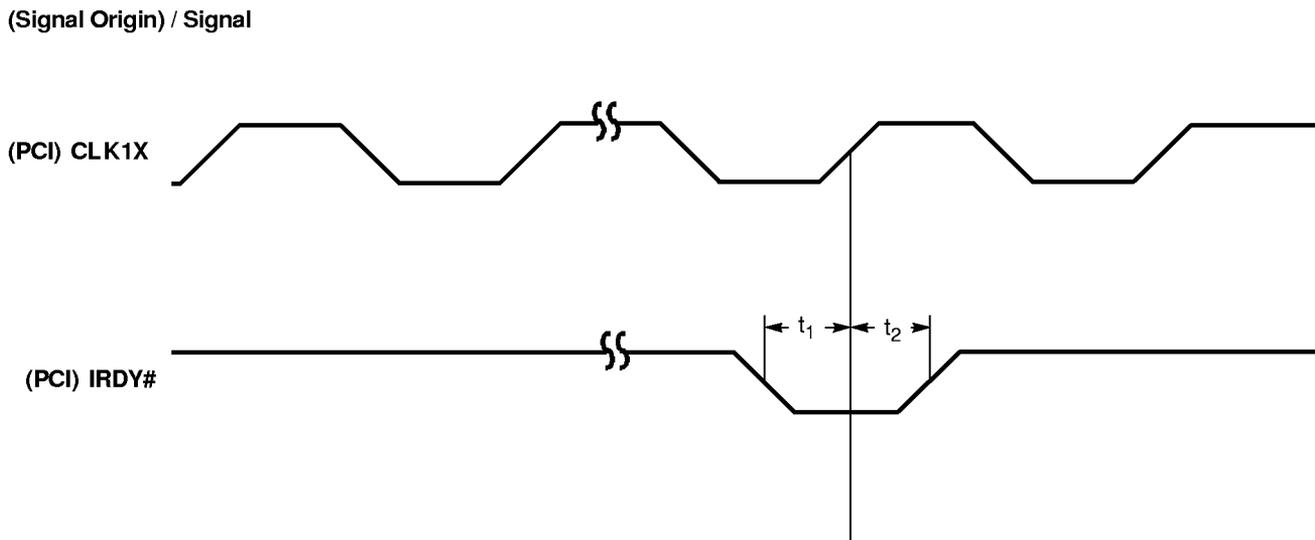
**Figure 1 3-10. PCI Bus — Read Dat a / IRDY# Timin g**
